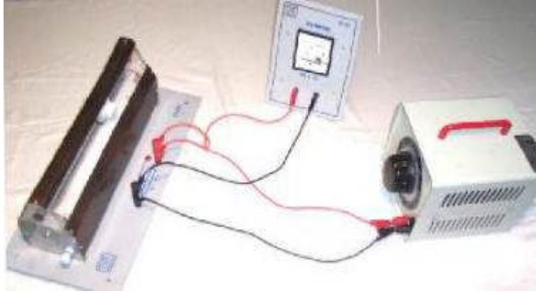
Resim 2.10: Voltmetrenin devreye bağlanması
