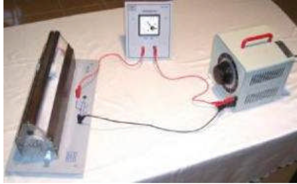
Resim 2.12: Ampermetre ile alıcı akımını ölçmek
