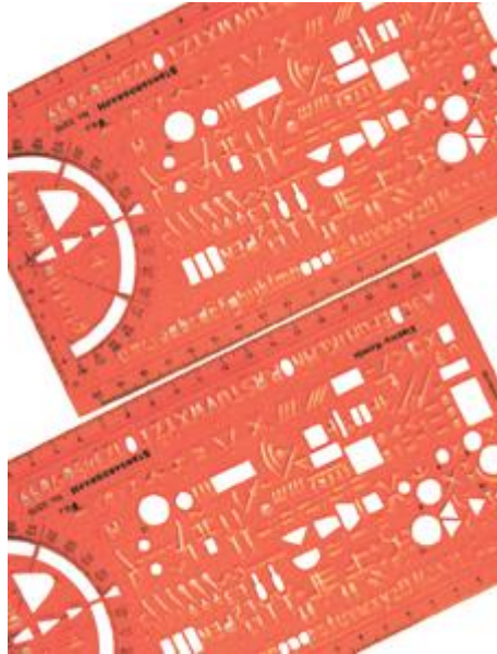
Resim 1.10: Elektrik-elektronik sembol şablonu
