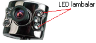
Resim 4.5: Lens kenarlarında LED ışıklara sahip bir WebCam
