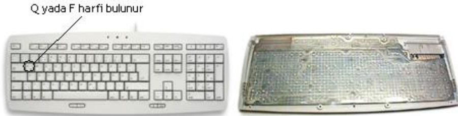
Resim 1.2: Klavyenin iç ve dış yapısı
