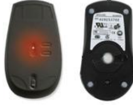
Resim 1.9: Optik ve mekanik farenin alttan görünüşü
