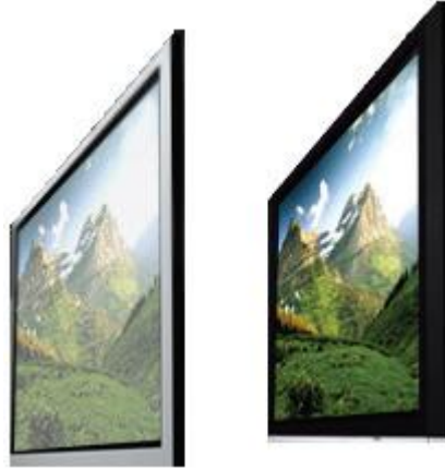
Resim 2.9: Görüş açısına göre LCD ve plazma farkı (plazma-lcd.tv)
