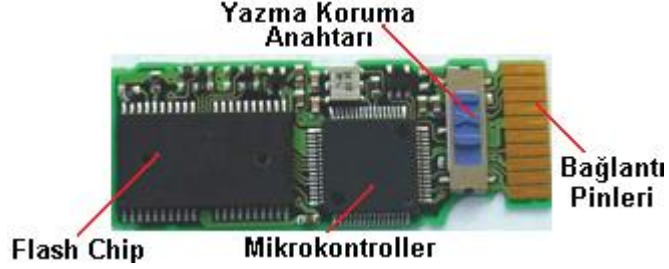
Resim 5.2: Hafıza kartı iç yapısı ve bileşenleri
