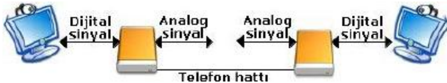
Şekil 2.6. Modem çalışma prensibi
